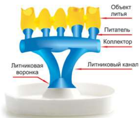
Рисунок 1.Литниковая система
